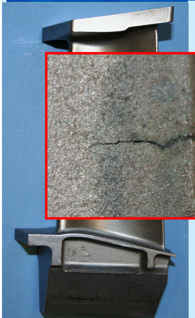
1 er étage aubes de turbine M53 (15 canaux) essais ONERA (1973)
